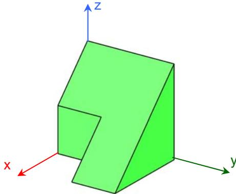
Das Ausgangsobjekt wird an der [zx]-Ebene gespiegelt.
