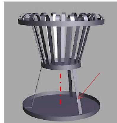
Der Seitenbügel (Pfeil) wird um eine Achse gedreht und mehrfach kopiert.
