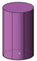
Ein Drehzylinder kann durch Verschieben eines Kreises erzeugt werden (Extrusionskörper).
